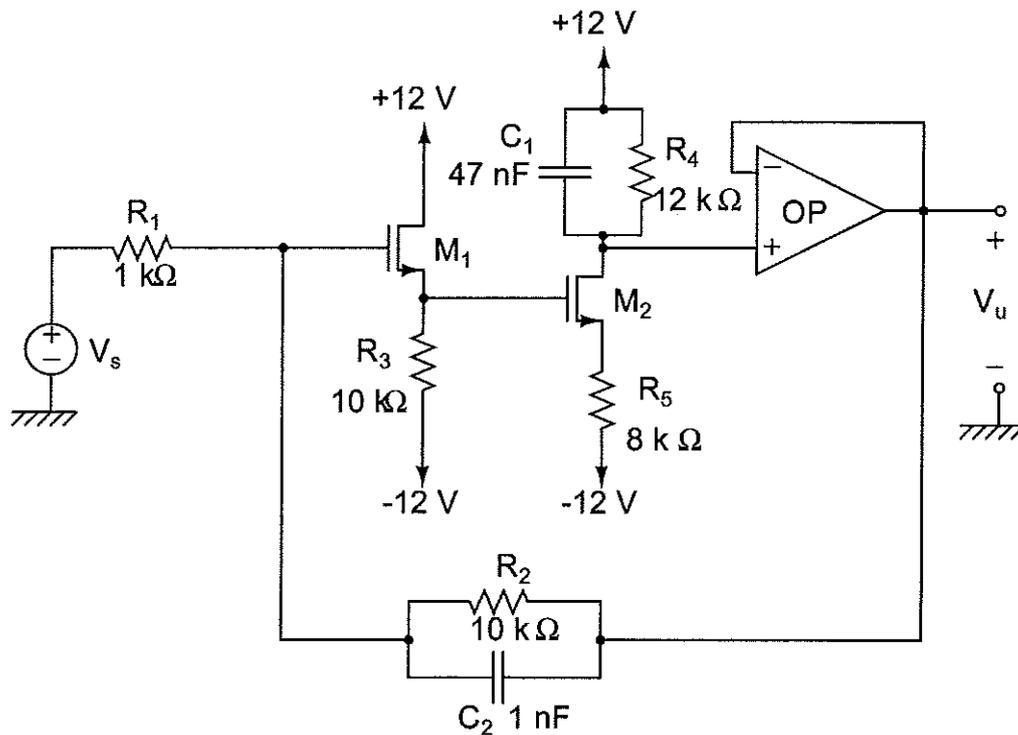
Con riferimento al circuito in figura, dove  $M_1$  ed  $M_2$  sono transistori MOSFET resistivi con  $I_D = k(V_{GS} - V_T)^2$ , ( $V_T = 1$  V e  $k = 1 \times 10^{-3}$  A/V<sup>2</sup>), OP è un amplificatore operazionale ideale ( $A_{vol0} \rightarrow \infty$ ,  $R_{in} \rightarrow \infty$ ,  $R_{out} \rightarrow 0$ ,  $f_p \rightarrow \infty$ ):
