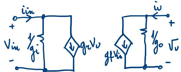
$$\begin{cases} i_u = g_f V_{in} + g_o V_u \\ i_{in} = g_i V_{in} + g_n V_u \end{cases}$$
