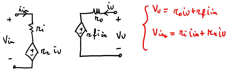
$$\begin{cases} V_u = r_o i_u + r_f i_{in} \\ V_{in} = r_i i_{in} + r_n i_u \end{cases}$$
